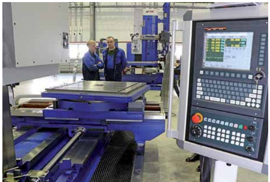
АО «ГРС-Урал», г. Екатеринбург горизонтально-расточной станок ГРС-100А (усовершенствованная версия горизонтально-расточного станка, выпускаемого компанией «TOS Varnsdorf» уже много лет.)
