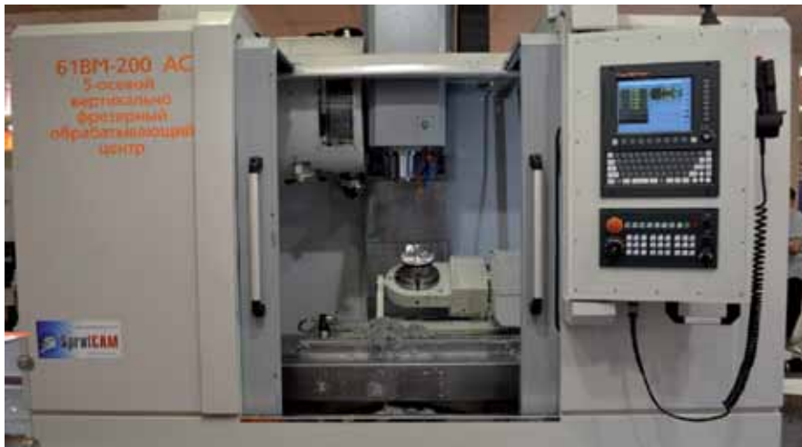
Станкозавод НПП «МЕАТЭК» 5-осевой вертикально-фрезерный обрабатывающий центр 61BM-200
