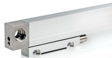
Фотоэлектрический преобразователь линейных перемещений закрытого типа **L18T** предназначен для преобразования линейных перемещений рабочих органов станков в электрические сигналы, содержащие информацию о величине и направлении перемещений. Отличается от преобразователей серии L18 способом крепления корпуса и более стабильными термическими характеристиками.
