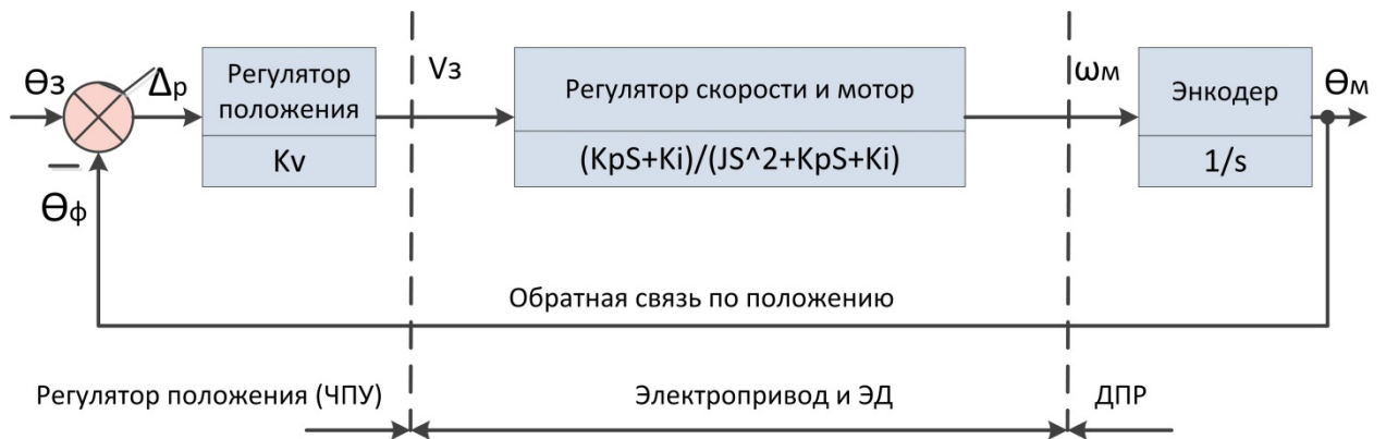
Рисунок 5 Система автоматического управление 3-го порядка преобразованная
