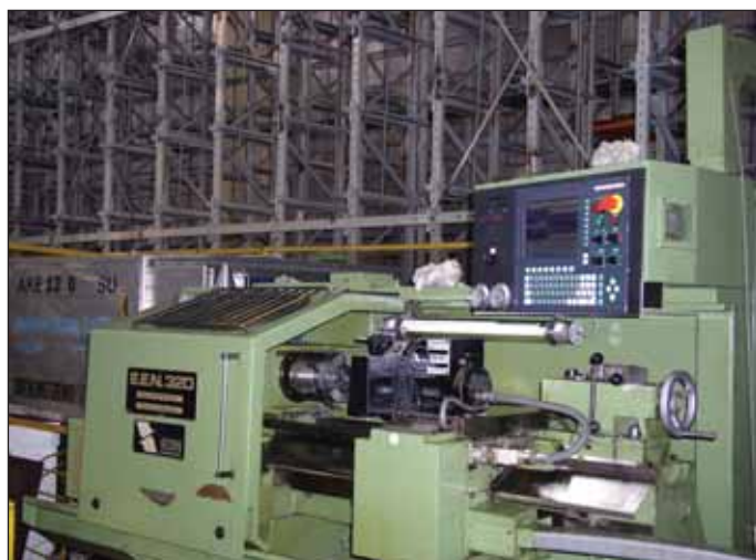
Рис. 12. Токарный станок с ЧПУ мод. EEN-320 (пр-во Венгрия, 1988 г.), на котором в 2004 г. неисправное УЧПУ PNC721 было заменено на УЧПУ NC200
