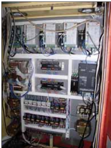
Рис. 9. Применение современных высокоточных цифровых приводов переменного тока позволило улучшить динамику приводов станка, значительно повысить скорость быстрого хода и производительность обработки
