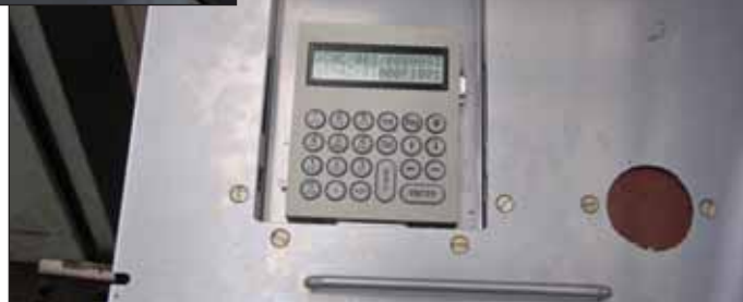
Рис. 17. Установка ЭСЗУ-К на откидной панели устройства ЧПУ модели H221M станка 16K30Ф325 (2003 г.)
