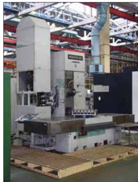
Рис. 10. Реконструированный обрабатывающий центр MCFHD-80 (производство ЧССР, 1986 г.), оснащенный УЧПУ NC110 и синхронным поворотным столом (ДНПП, 2003 г.)
