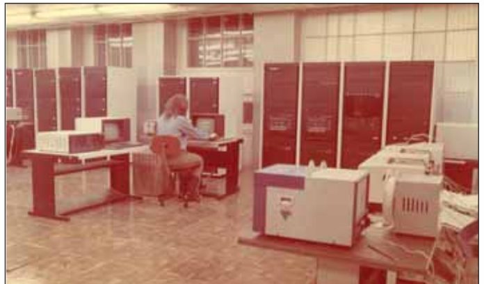
Рис. 20. Гибкий производственный комплекс и управляющий вычислительный комплекс на базе двух ЭВМ СМ-2М (1989 г.)
