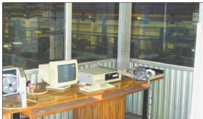
Рис. 21. Управляющий вычислительный комплекс на базе компьютеров IBM PC в составе локальной станочной сети ГПК после модернизации (2001 г.)
