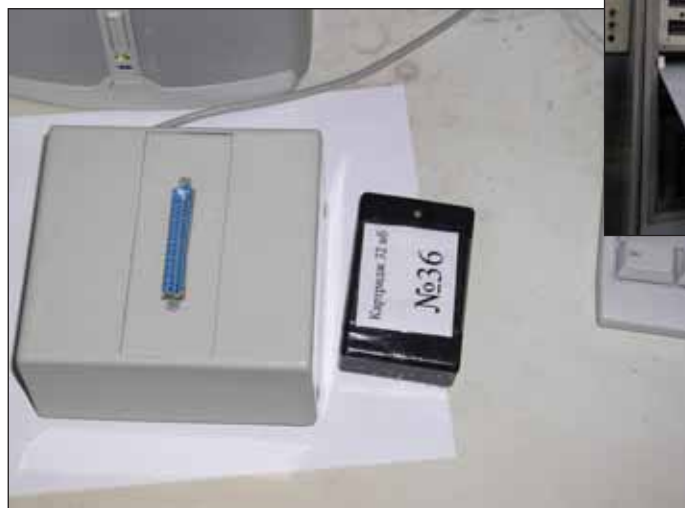
Рис. 16. Малогабаритное микропроцессорное устройство для записи УП на картридж с ПК через порт USB (разработка ДНПП, 2003 г.)
