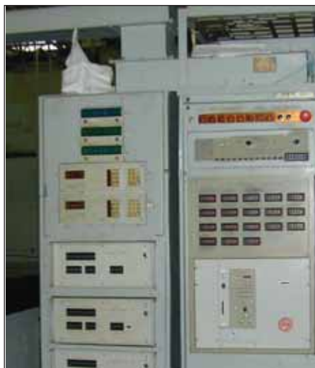
Рис. 13. Устройство ЧПУ "Луч 33" фрезерного станка ФП-7СМНЗ, оснащенное электронным считывающим записывающим устройством (ЭСЗУ) производства фирмы "Азик" (ДНПП, 2001 г.)
