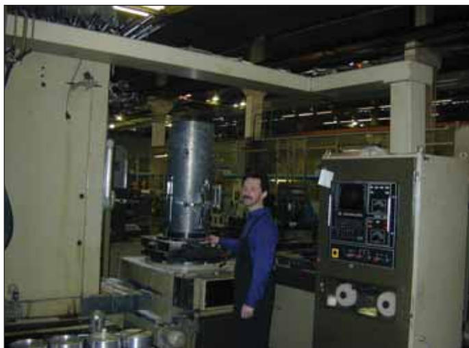
Рис. 21. Управляющий вычислительный комплекс на базе компьютеров IBM PC в составе локальной станочной сети ГПК после модернизации (2001 г.)
