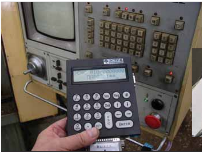
Рис. 18. Использование микропроцессорного ЭСЗУ-К для ввода-вывода управляющих программ и параметров в УЧПУ 2Р22 на токарном станке АТПУ-125-08
