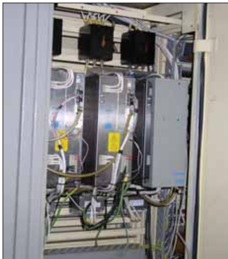
Рис. 9. Применение современных высокоточных цифровых приводов переменного тока позволило улучшить динамику приводов станка, значительно повысить скорость быстрого хода и производительность обработки
