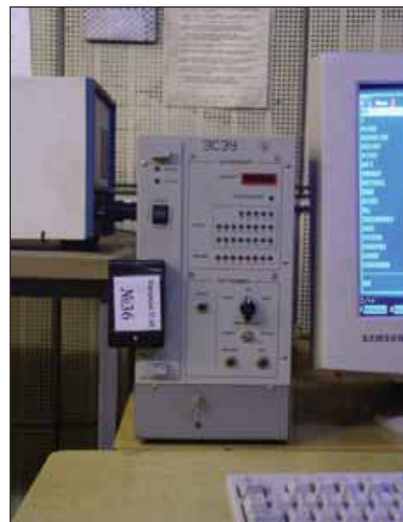
Рис. 15. Устройство для записи УП на картридж с компьютера на рабочем месте технолога-программиста
