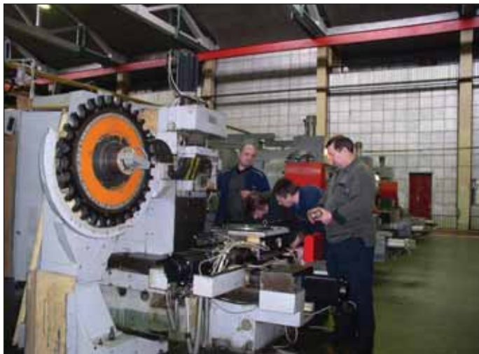
Рис. 7. Специалисты отдела главного механика ОАО ДНПП проводят работы по комплексной модернизации обрабатывающего центра модели 2202ВМФ4 (производство завода "Жальгирис", г. Вильнюс, 1987 г.) с заменой УЧПУ 2С42-65 на NC200
