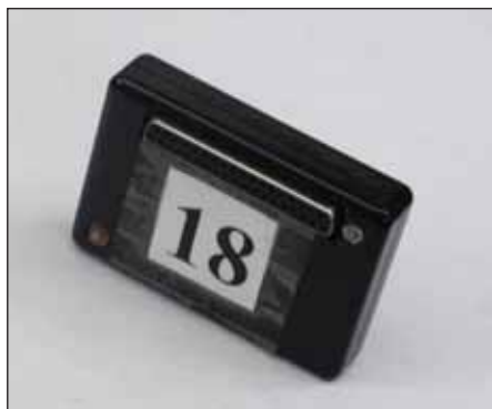
Рис. 14. Энергонезависимый картридж (разработка ООО "Азик") для передачи управляющих программ на станки с ЧПУ. Объем картриджа — 32, 128 и 256 Кбайт, срок службы — 10 лет
