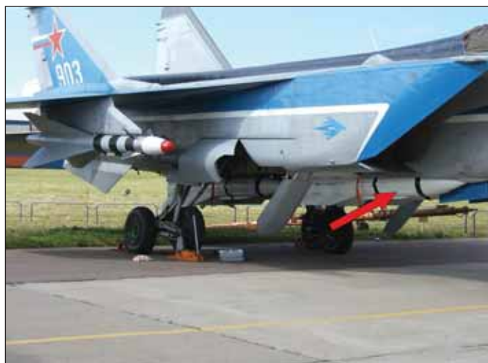
Рис. 2. Ракеты "воздух-воздух" Р-33 на самолете МИГ-31 в составе системы управления вооружением "Заслон"
