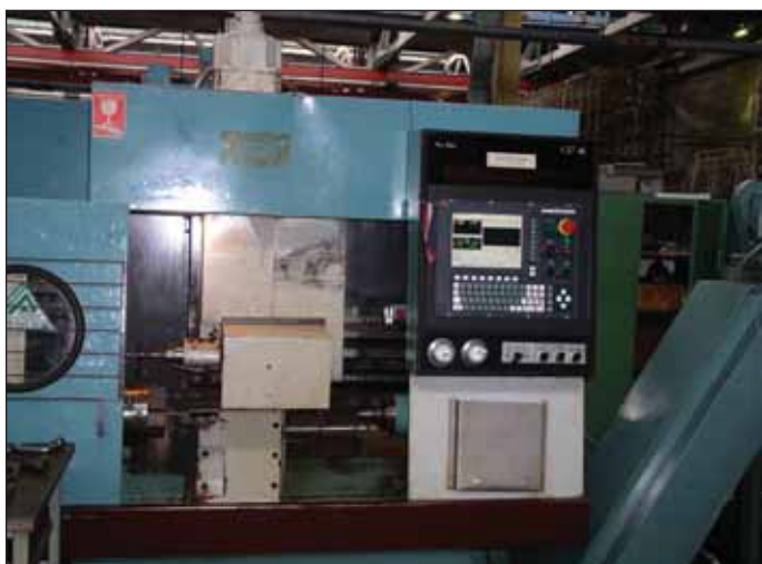
Рис. 11. Токарный станок с ЧПУ мод. SPT16NC (пр-во ЧССР, 1987 г.), на котором устаревшее УЧПУ NS660 было заменено на NC200 фирмы "Балт-систем" (ДНПП, 2003 г.)
