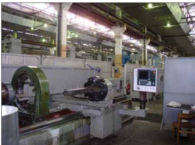
Рис. 5. Реконструированный токарный станок РТ755Ф3-01, оснащенный УЧПУ NC200 фирмы "Балт-систем" (ДНПП, 2001 г.)
