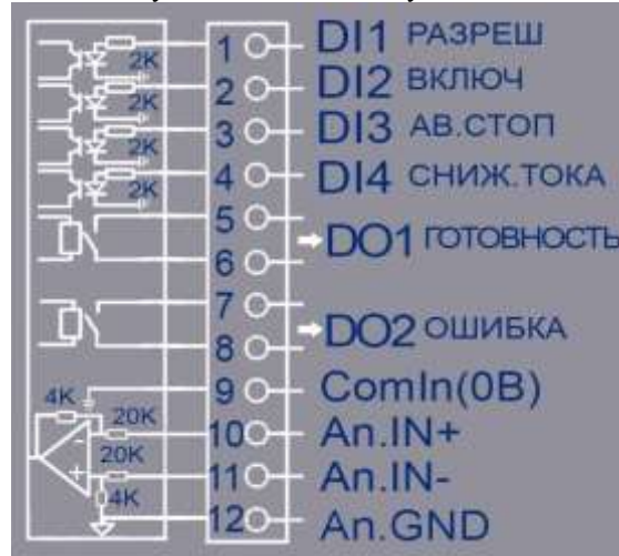
Рисунок 3.14 - Расположение контактов разъёма «X4» преобразователя BSD
