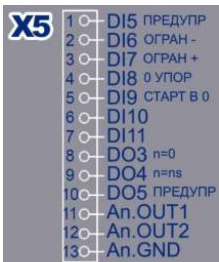
Рисунок 3.15 - Расположение контактов разъёма «X5» преобразователя BSD
